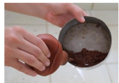
Figura 7 – Retirada da água limpa da cápsula com o solo desprendido
