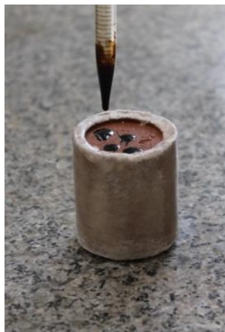
Aplicação da imprimadura no CP
