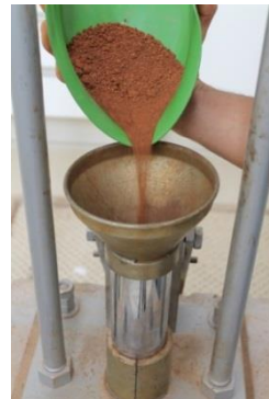
Adição da porção de solo a ser compactada
