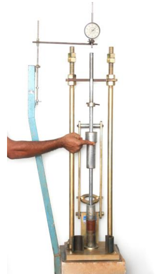
Figura 3.1 – Equipamento utilizado no Ensaio de Compactação.
