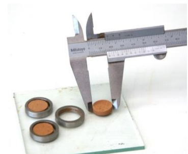
Figura 3.8 – Determinação da contração diametral do Método Expedito da Pastilha.
