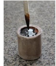
Figura 3.9 – Ensaio de Penetração da Imprimadura Betuminosa.
